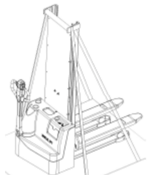
Fig. 6: Points de fixation
