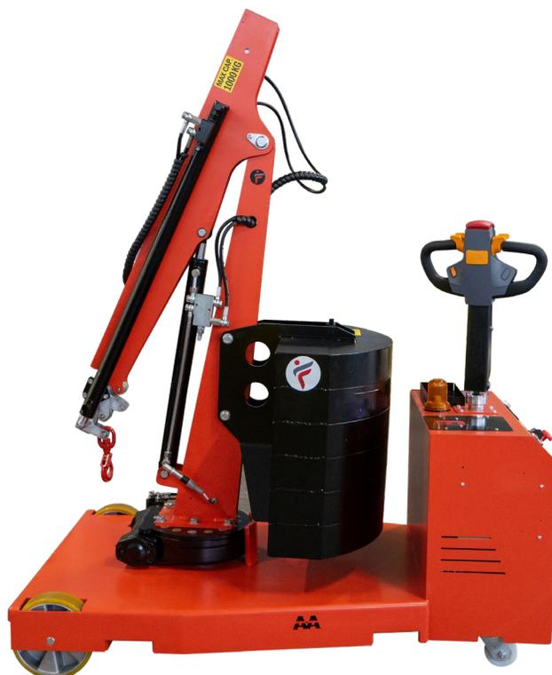
SCP1000DBR / SCP1000DBL est une grue motorisée rotative à contrepoids qui permet de soulever et de transporter des charges jusqu'à 1.000 kg. Mât sur tourelle rotative électrique. Équipée de 2 roues fixes et de 2 roues stabilisatrices pivotantes. Roue motrice auto-freinante pour une maniabilité aisée dans les espaces confinés.
