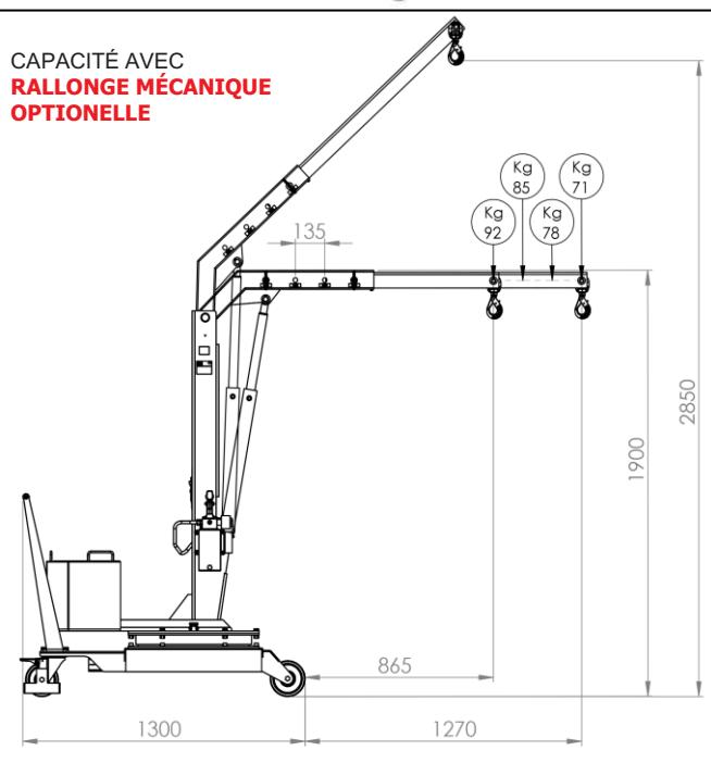
**SCP01B2P****Déplacement manuel****CARACTÉRISTIQUES PRINCIPALES****CAPACITÉ 200 KG**
