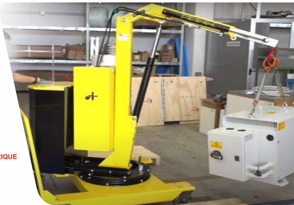
█ CAPACITÉ 500 kg    █ HAUTEUR MAX. 2860 mm    █ MÂT rotatif 360°    █ PORTE-À-FAUX MAX. 1312 mm
