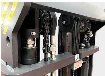
Un système ingénierie d'amortisseurs et sensors a été mis en place afin de limiter au maximum les vibrations et les à-coups ressentis par l'opérateur lors des phases d'extension du mât.
