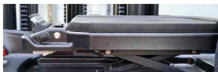
Le pupitre de commande est coulissant et ajustable en hauteur; il dispose également d'un espace de rangement.
