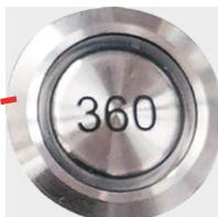
Le système de direction assistée électronique (ACEPS) rend la direction souple et précise. La direction électrique à 180°/360° peut être actionnée en temps réel en appuyant simplement sur un interrupteur.
