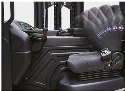
Siège sur amortisseur réglable et inclinable.
