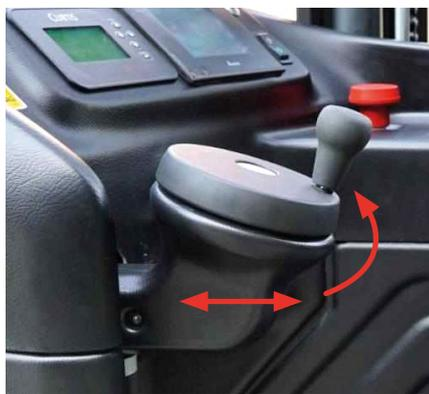
Le volant de direction est ajustable en hauteur et en profondeur pour un plus grand confort et une meilleure position de conduite.
