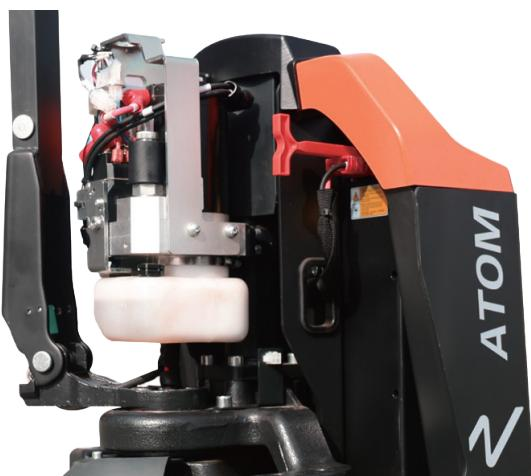
Le design classique est conservé pour réduire les taux de défaillance. Les systèmes hydrauliques et électriques sont intégrés de manière à faciliter l'entretien.
