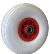
RINC Roue premium en mousse increvable non tâchante silencieuse, avec corps en PP haute densité et roulement à billes double étanchéité 6004 2RS Diamètre : 260mm
