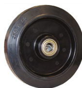
RSN Roue premium en caoutchouc élastique noir silencieux, avec corps en polyamide 6 et roulement à billes double étanchéité Diamètre : 250mm
