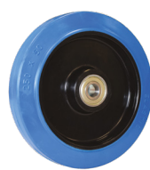
RSB Roue premium en caoutchouc élastique bleu non tâchant silencieux, avec corps en polyamide 6 et roulement à billes double étanchéité Diamètre : 250mm
