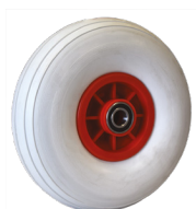
RINC Roue premium en mousse increvable non tâchante silencieuse, avec corps en PP haute densité et roulement à billes double étanchéité 6004 2RS Diamètre : 260mm
