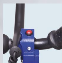
INTERRUPTEUR DE MONTÉE ET DE DESCENTE Facilite la montée lorsque le timon est replié
