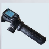
DÉPLACEMENT MOTORISÉ SUR DONKEY LIGHT XX Réglage proportionnel de la vitesse avec accélérateur
