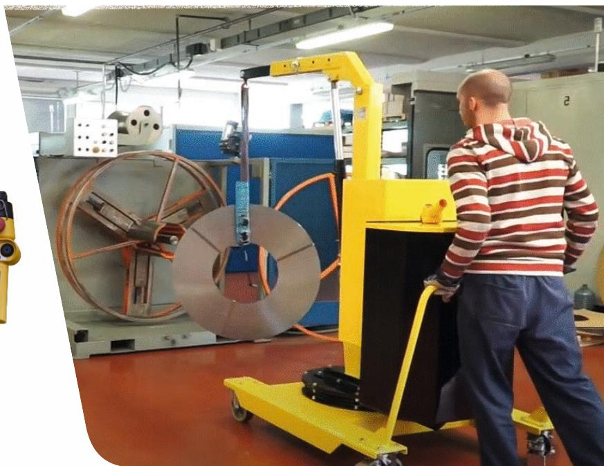
CAPACITÉ 200 kg     HAUTEUR MAX. 2850 mm     MÂT rotatif 360°     PORTE-À-FAUX MAX. 1270 mm
