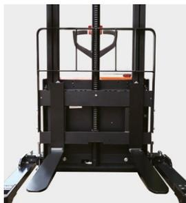
Les longerons encadrants sont fixés par des vis situées à l'extérieur du châssis du gerbeur (quatre vis de chaque côté). Les longerons peuvent être facilement ajustés sur la largeur. Le gerbeur peut ainsi avoir une largeur totale en mm de : 1181/1281/1381/1481.
