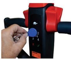
Ecran LCD et démarrage par code PIN et/ou RFID
